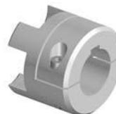
Moyeu de blocage réalisé avec **double fente et rainure de clavette**. Depuis la taille 24/28. La pression de blocage élimine le jeu de denture lors des inversions de couple.
