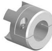
Moyeu de blocage réalisé avec **double fente sans rainure de clavette**. Depuis la taille 24/28. Moyeu conçu sans jeu de denture. Le couple transmissible dépend du diamètre de l'alésage.
