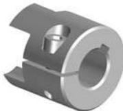
Moyeu de blocage réalisé avec **simple fente et rainure de clavette**. Jusqu'à la taille 19/24. La pression de blocage élimine le jeu de denture lors des inversions de couple.
