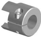
Moyeu de blocage réalisé avec **simple fente sans rainure de clavette**. Jusqu'à la taille 19/24. Moyeu conçu sans jeu de denture. Le couple transmissible dépend du diamètre de l'alésage.
